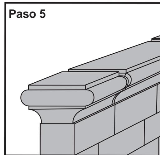
Paso 5. Una vez que el concreto pueda soportar su propio peso, se deben quitar las formas. Retire las abrazaderas de resorte y tire de la forma hacia abajo y hacia afuera, exponiendo la cara para terminar.
