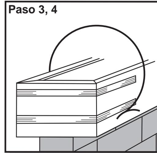
Paso 3. Para obtener mejores resultados, corte las esquinas a inglete. Para reforzar las esquinas, fíjelas con cinta adhesiva.
