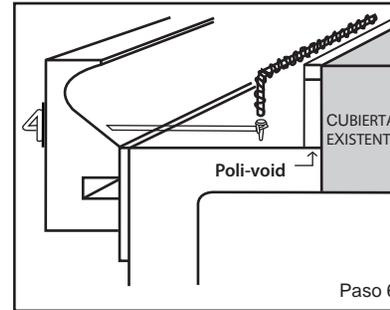
**Paso 6.** Aplique adhesivo en aerosol a la plataforma existente. Deje reposar 1 minuto. Con la tira de rasgado perforada hacia arriba, presione el nivel Poli-Void a la plataforma existente.
