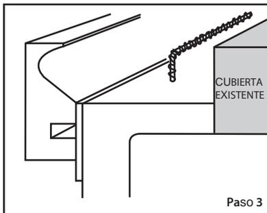
**Paso 3.** Despegue el papel de la cinta de doble cara un pie a la vez, pegando la forma al azulejo con el borde inferior del perfil de la forma, incluso con la parte superior del azulejo.
