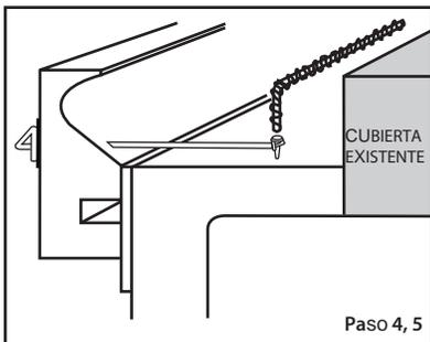
**Paso 5.** Coloque la rondana de plástico (incluida) en el alambre de amarre. Empuje el alambre de amarre a través de la forma, incluso con la parte superior de la loseta. Envuelva el extremo del alambre de amarre alrededor del clavo de concreto, aplicando una ligera presión.
